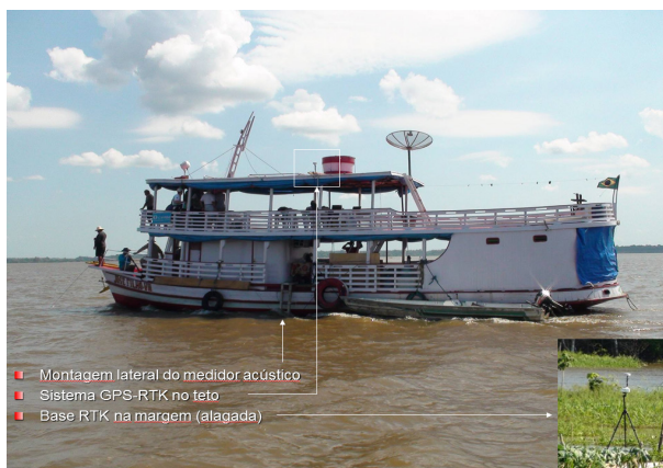
Figura 51: Medição de descarga líquida pelo método acústico em grandes rios.
