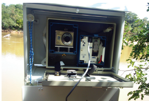
Figura 8: Linígrafo de boia digital.
