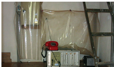
Figura 6: Linígrafos de pressão: de bolhas e transdutor eletrônico.
