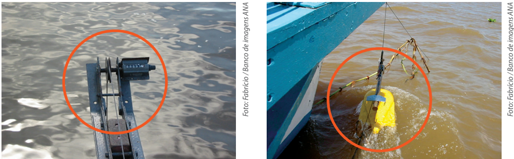
Figura 23: Estrutura do Guincho (Cabo de Aço e Medidor da Profundidade do Molinete) e do Molinete e Lastro (Formato Hidrodinâmico)
