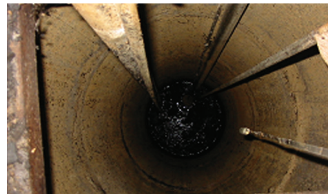
Figura 5: Linígrafo de bóia (modelo Stevens) e poço tranquilizador.
