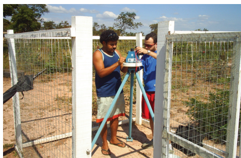
Figura 11: Pluviógrafo digital (sensor de chuva com datalogger).
