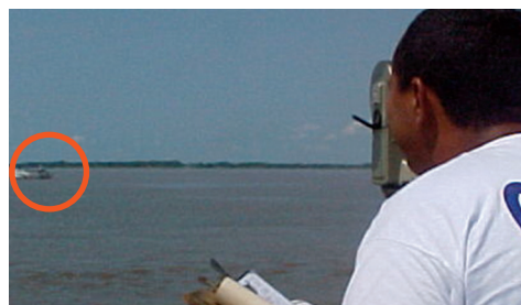
Figura 36: Posicionamento do Barco durante a Medição utilizando Teodolitos.
