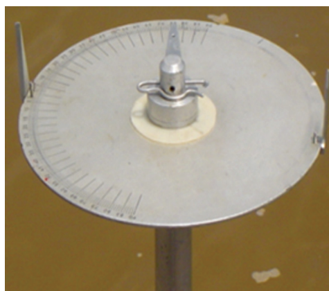
Figura 44: Eixo vertical fixado na proa do barco e medidor de ângulo
