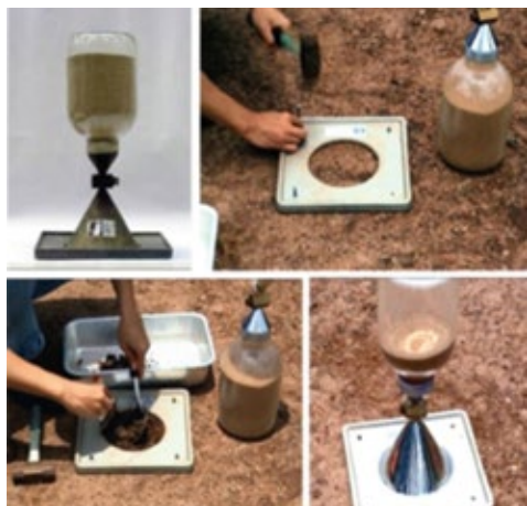
Figura 21. Determinação do peso específico do solo com frasco de areia.
