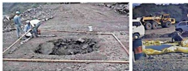
Figura 23. Ensaio de densidade in situ de enrocamento.
