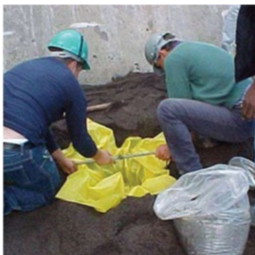
Figura 22. Ensaio de densidade in situ de material de transição.
