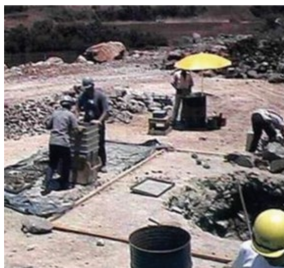
Figura 24. Ensaio granulométrico in situ de enrocamento.
