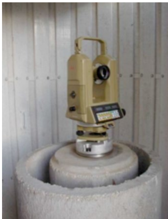
Figura 55. Marco de referência com teodolito.
