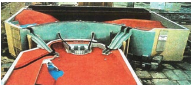
Figura 30. Modelo hidráulico utilizado no estudo do vertedouro de superfície e dos descarregadores de meio-fundo de uma barragem em arco.
