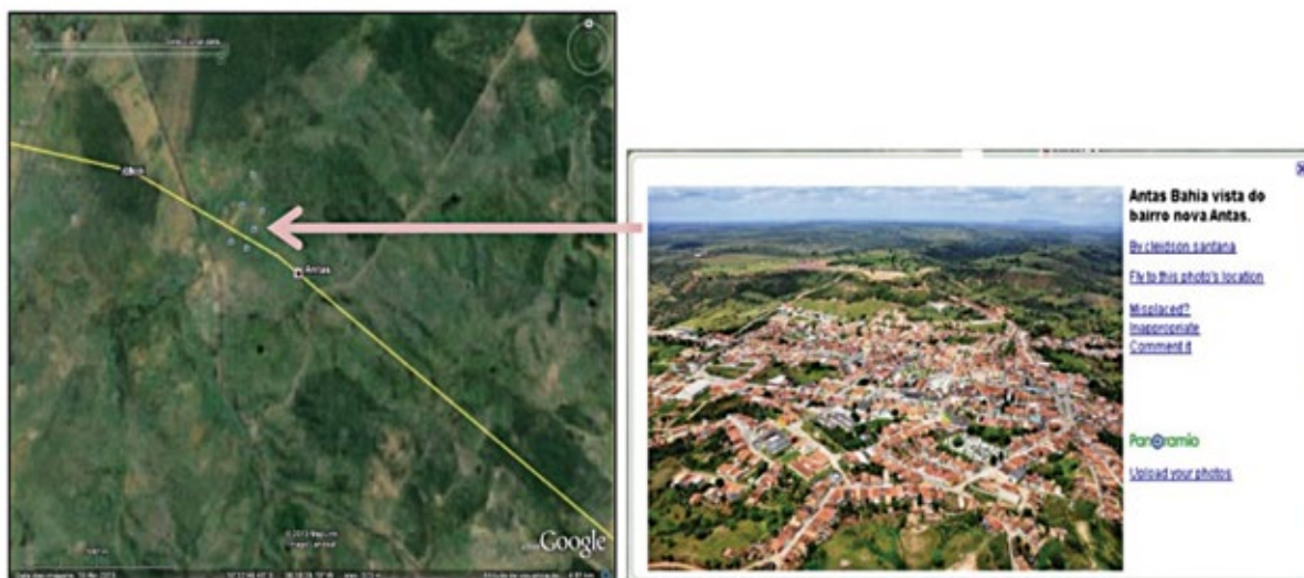
Figura 7 – Exemplo de imagem do Google Earth para identificação dos elementos em risco no vale a jusante
