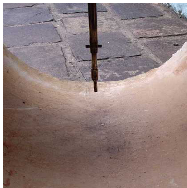
Foto 2. Tubo de Pitot sendo inserido até o fundo da tubulação.
