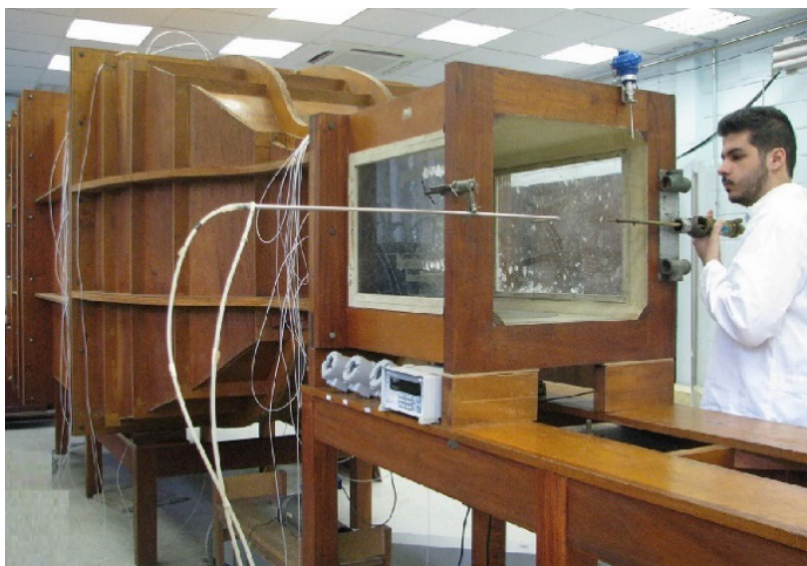
Figura 15. Calibração de tubo de Pitot do tipo Cole em túnel de vento aerodinâmico.
