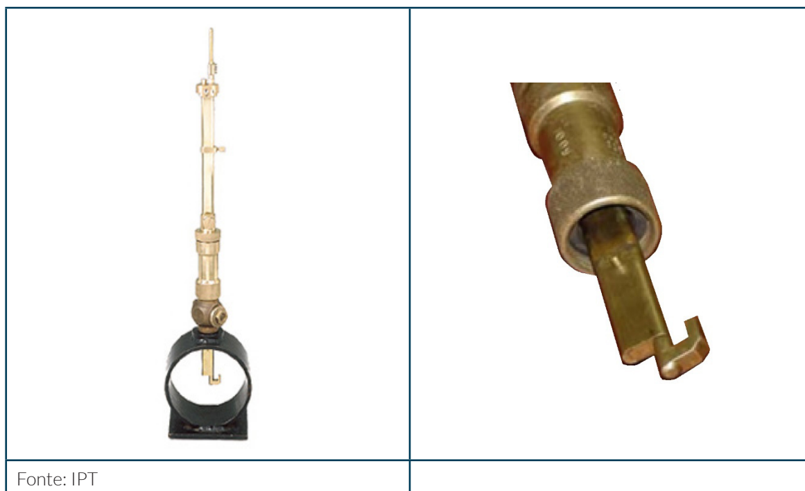
Figura 84. Calibre ou galgador de um tubo de Pitot do tipo Cole.
