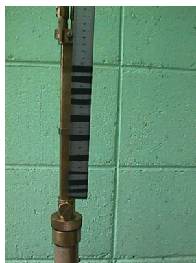
Foto 4. Posicionamento do tubo de Pitot no ponto de medição.
