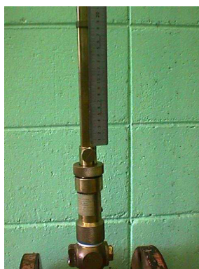
Foto 5. Medição do deslocamento máximo do tubo de Pitot
