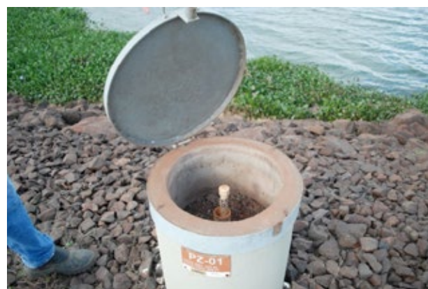
Figura 1.9. Piezômetro de tubo na barragem de Canoas II (Brasil) bem identificado e com boa proteção. Fonte: Arquivo SBB Engenharia.
