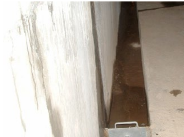
Figura 1.15. Medidor de vazão na barragem de Meimoa (Portugal).
