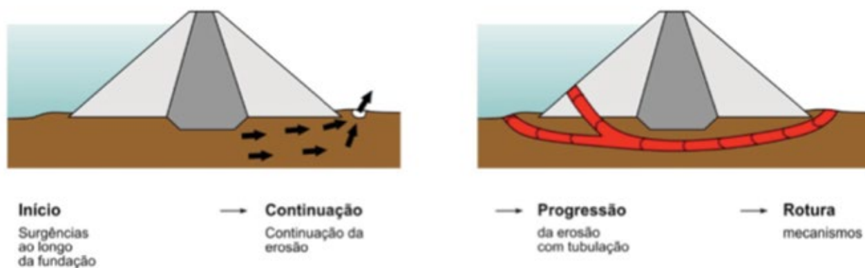
Figura 5. Problemas de percolação. Fonte: Adaptado de Foster (1999).
