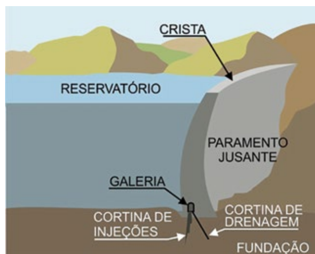
Figura 22. Componentes de uma barragem de concreto. Fonte: COBA.
