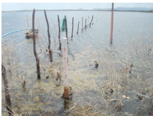
Figura 1.8. Barragem de Baião (Paraíba) – escalas para registro do nível de água do reservatório. Fonte: COBA.
