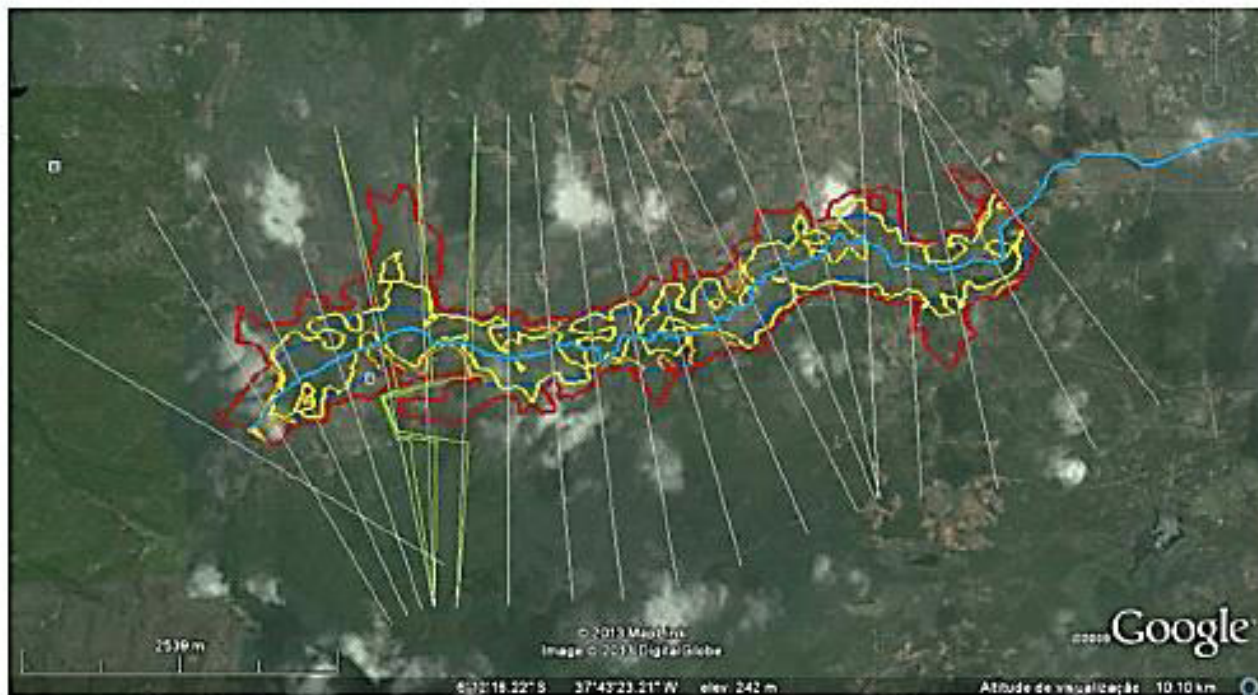
Figura 4. Áreas potencialmente afetadas e desenho das seções utilizadas para a sua determinação importadas para o Google Earth. Classificação de Barragens da ANA
