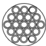
(a) Retificador de escoamento do tipo feixe de 19 tubos.
