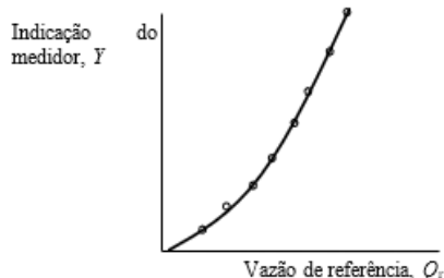
Figura 22. Curva característica de um medidor de vazão não-linear.
