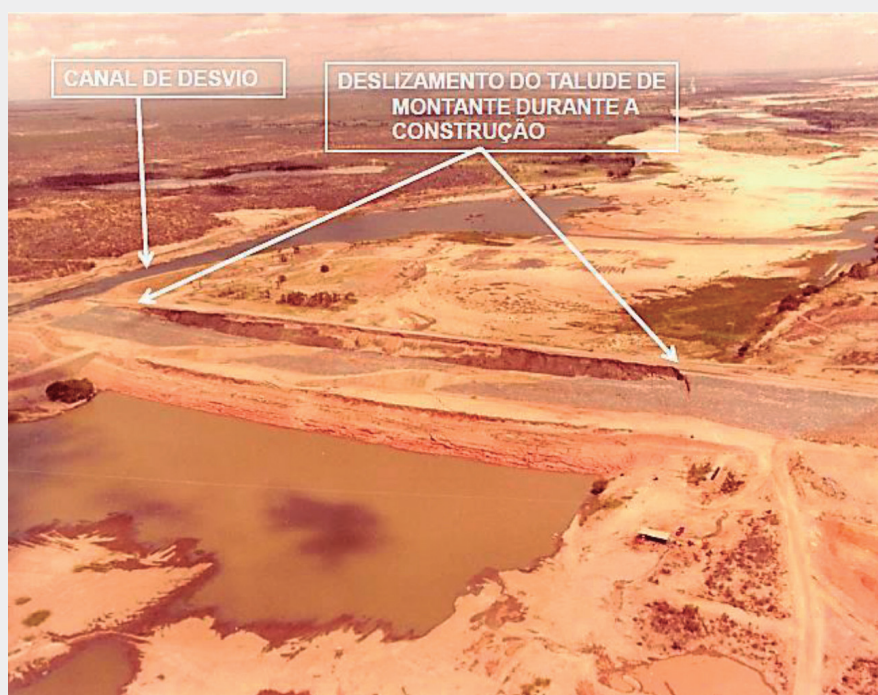
Figura 1.16 – Ruptura do paramento montante da barragem do Açú em 1982 (Sandroni, 1982)
