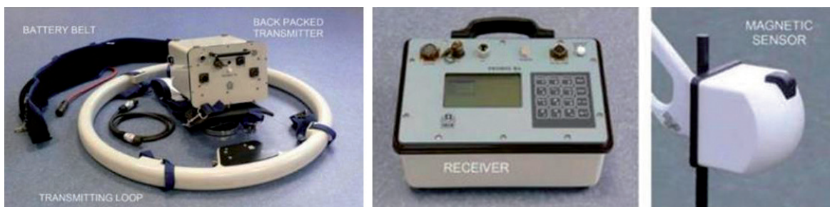
Foto 29: Equipamento utilizado para levantamento eletromagnético Promis 10
