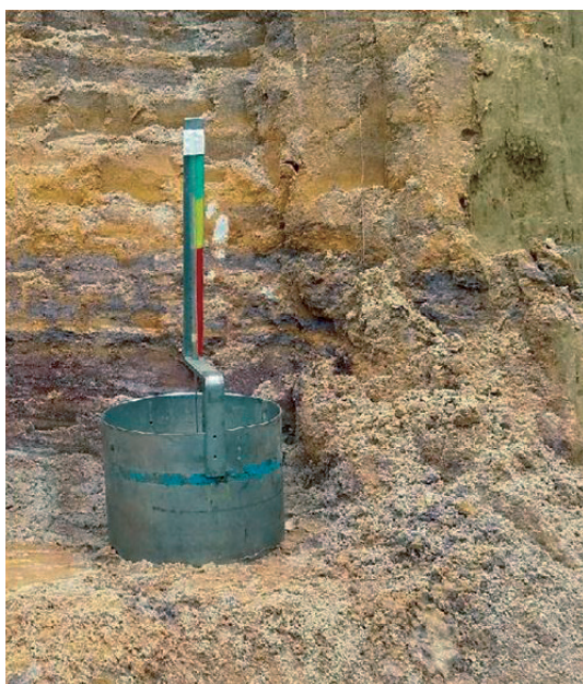
Foto 58: Infiltrômetro de anel ( single ring ) utilizado nas avaliações de velocidade de infiltração básica das principais classes de solos da Ilha de São Luís – Maranhão
