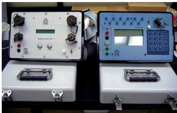
Foto 28: Equipamentos utilizados para levantamento geofísico elétrico: à direita resistivímetro Syscal Pro e a esquerda o comutador Switch Pro 72
