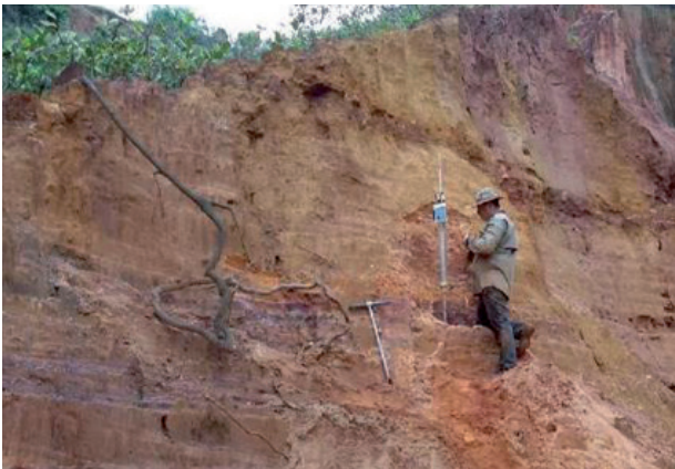
Foto 61: Avaliações de condutividade hidráulica saturada (kfs) e da velocidade de infiltração básica (VIB) na Falésia de Araçagi aproximadamente 10 m e 30 m da superfície
