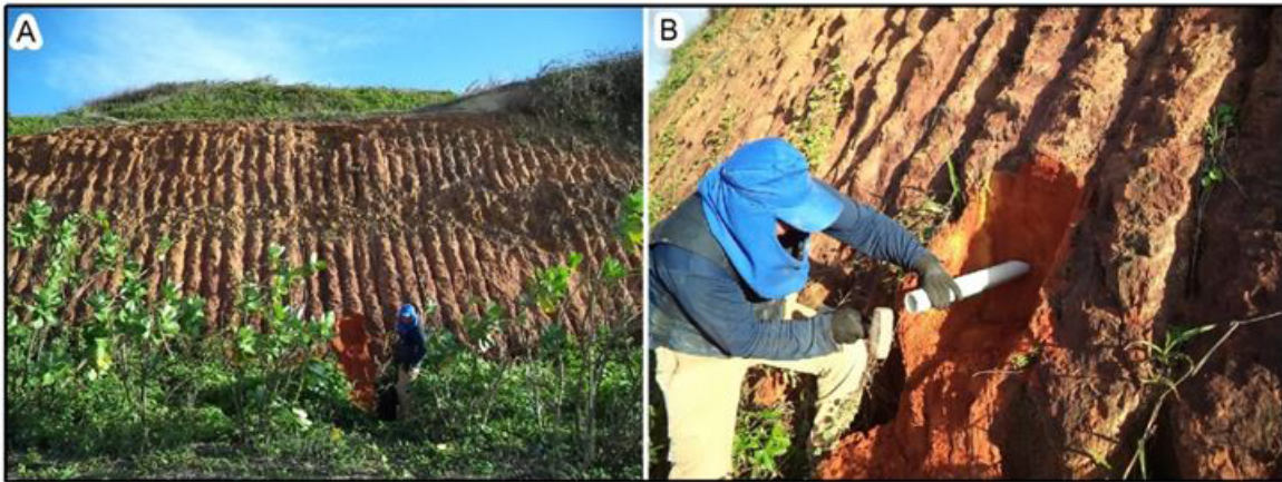
Foto 8: Visão frontal do afloramento (A) e inserção do tubo de coleta (B).
