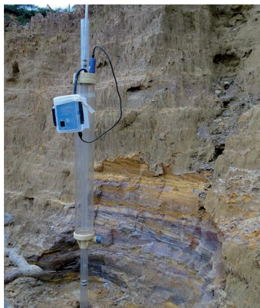
Foto 59: Permeâmetro de Guelph utilizado nas avaliações da condutividade hidráulica saturada das principais classes de solos da Ilha de São Luís
