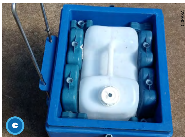
Figura 2.2 – Amostragem realizada em um dos pontos de monitoramento (a) com detalhes do compartimento interno superior (b) e inferior (c) do amostrador automático de líquidos Étsus 1000
