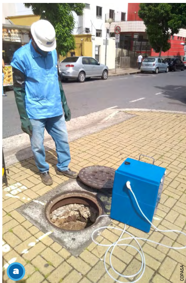
Figura 2.2 – Amostragem realizada em um dos pontos de monitoramento (a) com detalhes do compartimento interno superior (b) e inferior (c) do amostrador automático de líquidos Étsus 1000
