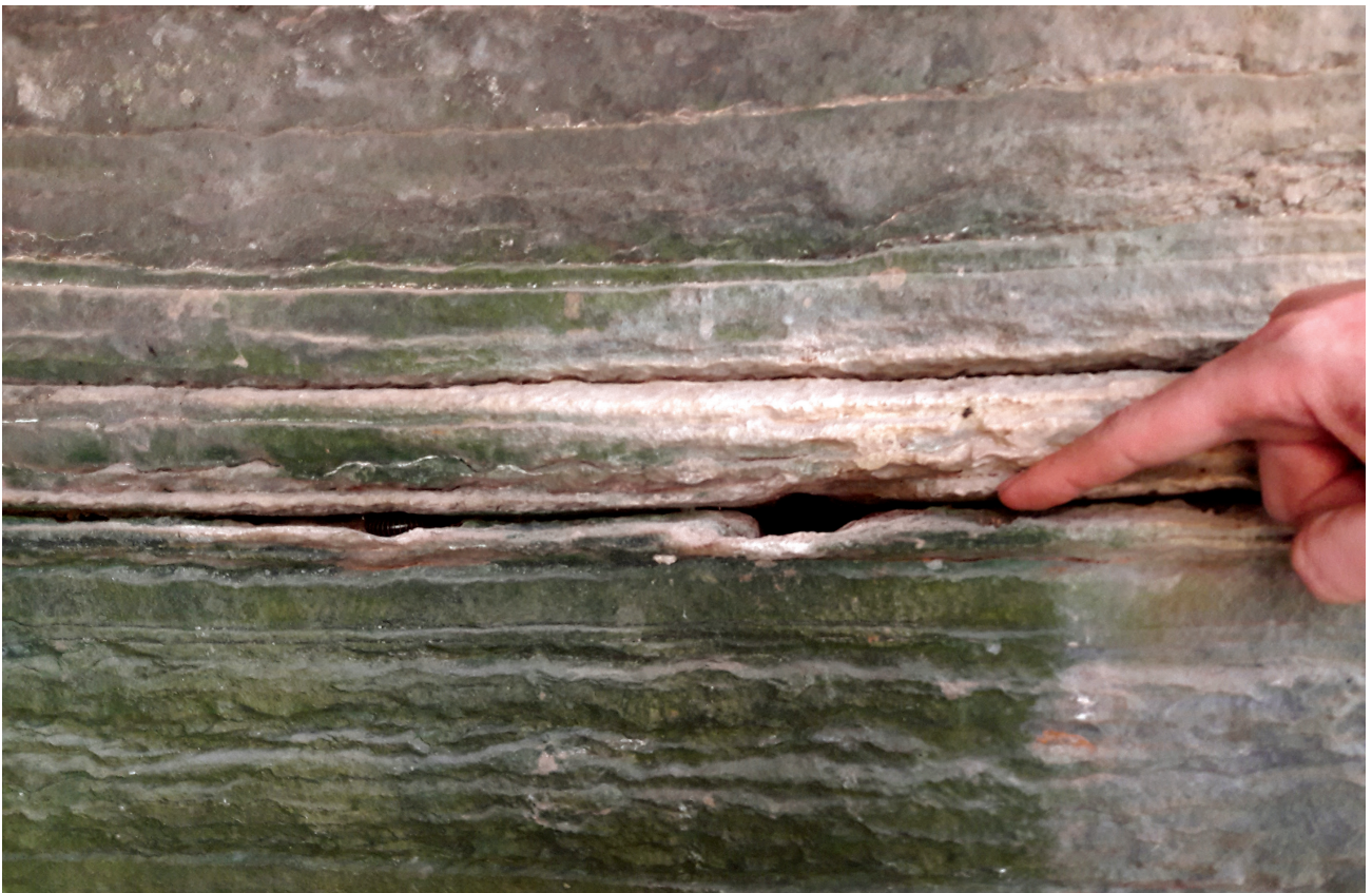
Figura 14 – Proceso inicial de karstificación en roca caliza en ensanchamiento en los planos de estratificación de la roca (discontinuidades), por los que circuló el flujo de agua acidificada.
