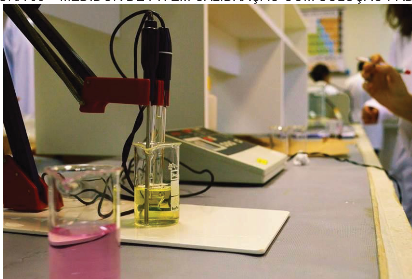
FIGURA 05 – MEDIDOR DE PH EM CALIBRAÇÃO COM SOLUÇÃO PADRÃO
