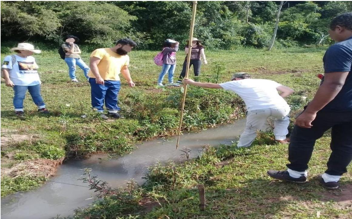
Fonte: o autor, 2019. Medição da profundidade do córrego com uma vara de bambu para se calcular a vazão utilizando o método do flutuador em um trecho de uma bacia hidrográfica no município de São Carlos- SP durante a prática, em 14/12/2019.
