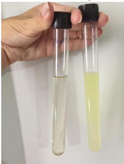
Figura 8: Tubos de ensaio para leitura de presença (tubo direito) ou ausência de coliformes (tudo esquerdo)
