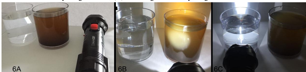
Figuras 6: (A) – Montagem do experimento de turbidez; (B) – Interferência: passagem de luz por água turva; (C) – Passagem de luz por água cristalina
