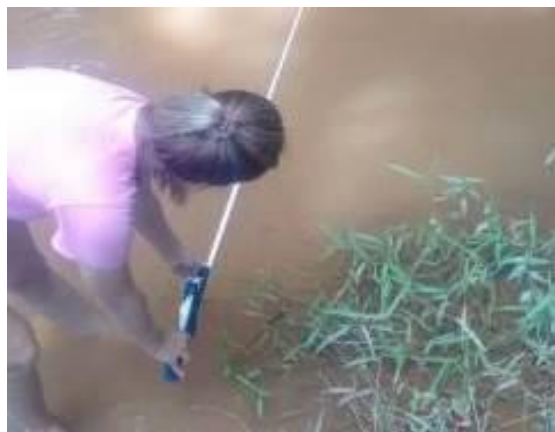
Figura 4: Medição para cálculo de área da seção transversal monitorada, ponto 1 à montante.
