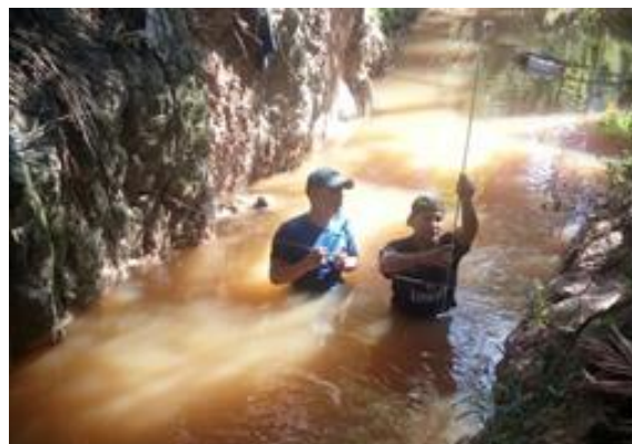
Figura 3: Medição da velocidade com o uso do molinete, ponto 2 à jusante.
