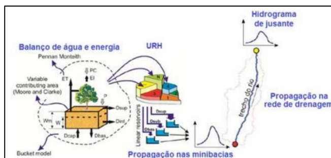
Figura 3: Representação esquemática da estrutura do modelo hidrológico-hidrodinâmico MGB
