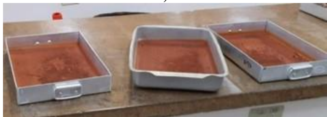
Figura 5: Coleta de sedimentos do ensaio de SC: a) água escoada e sedimentos e b) sedimentos secos.
