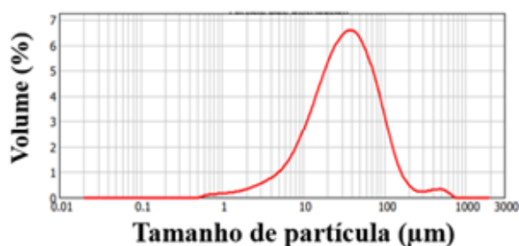
Figura 2: Granulometria dos sedimentos do rio Pirai usados no processo de calibração do turbidímetro.
