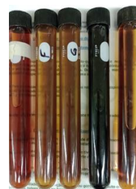
Figura 3: Comparação das amostras obtidas com uma solução padrão. Da esquerda para direita: Solução padrão, sedimento fino da amostra 1, sedimento grosso da amostra 1, amostra 2 e amostra 3.
