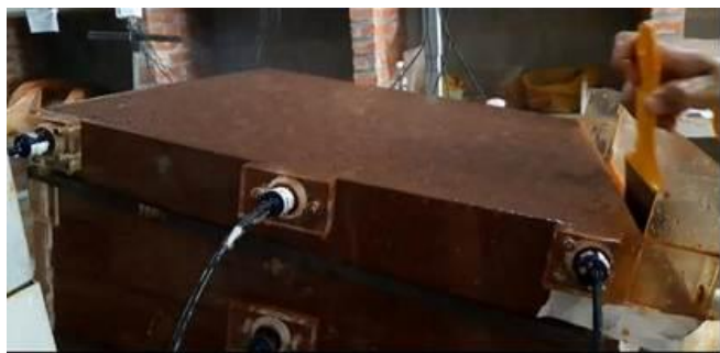
Figura 4: Realização do ensaio de erosão pluvial, com detalhamento da água e sedimento sendo escoados para a calha.
