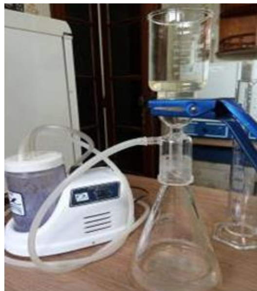
Figura 7: Método de filtração, evaporação e pesagem.
