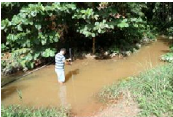
Figura 2: Medição da velocidade com o uso do molinete, ponto 1 à montante
