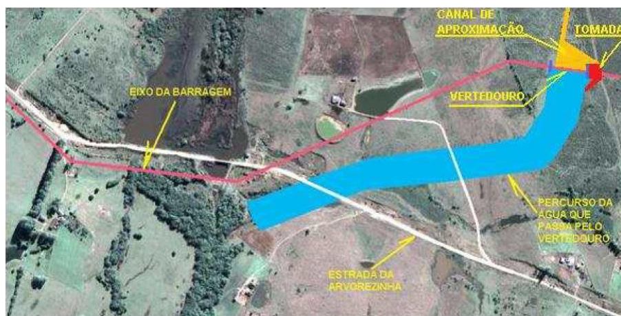
Figura 2 - Arranjo geral esquemático da Barragem. Fonte: Barragem da Arvorezinha, Bagé/RS, p. 35, 2011.
