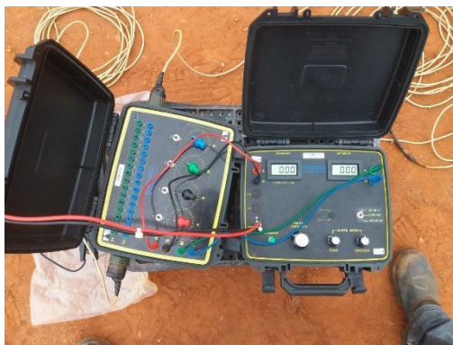
Figura 3.1 – Imagem obtida em campo do equipamento utilizado em campo para aquisição dos dados geoeletricos.
