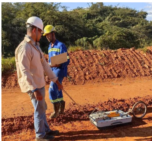
Figura 3.1 – Imagem obtida em campo do equipamento empregado nas investigações de GPR.
