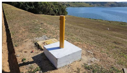
Figura 10 – Novo instrumento instalado e com pintura nova ao lado do instrumento antigo.
