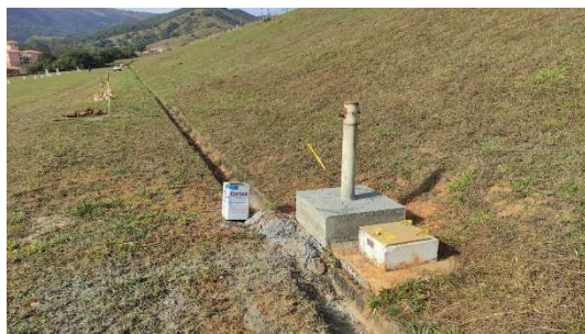
Figura 9 – Terminal do novo instrumento finalizado (sem pintura) ao lado do instrumento antigo.
