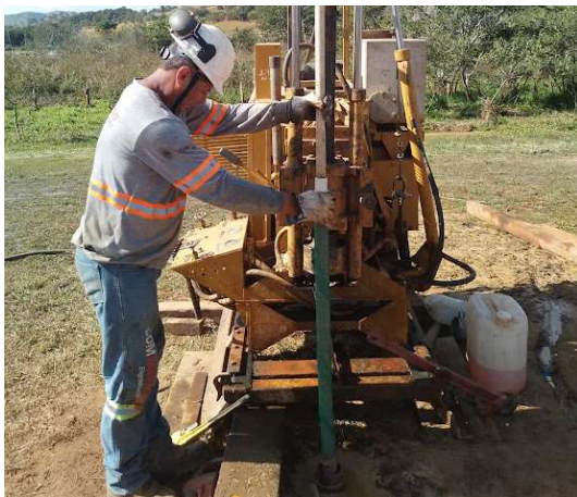
Figura 5 – Inserção do bulbo do instrumento no furo de sondagem.
