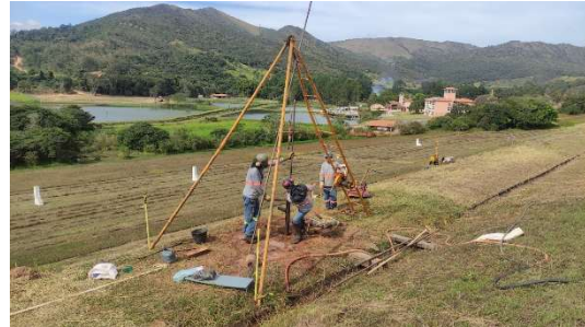
Figura 2 – Perfuração a trado/SPT no talude de jusante
