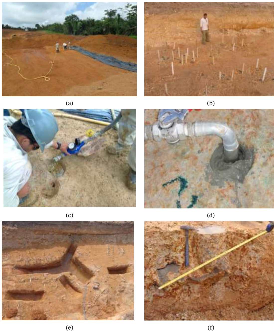
Figura 2-4 – Etapas de identificação em campo de canalículos para fundação de barragens (fotos do autor). (a) Raspagem mecânica e limpeza. (b) Identificação e classificação dos canalículos. (c) Teste de infiltração do canalículo. (d) Teste de injeção de calda de cimento no canalículo. (e) Execução de poços e trincheiras nos canalículos com maiores absorções. (f) Mapeamento detalhado das paredes das escavações.
