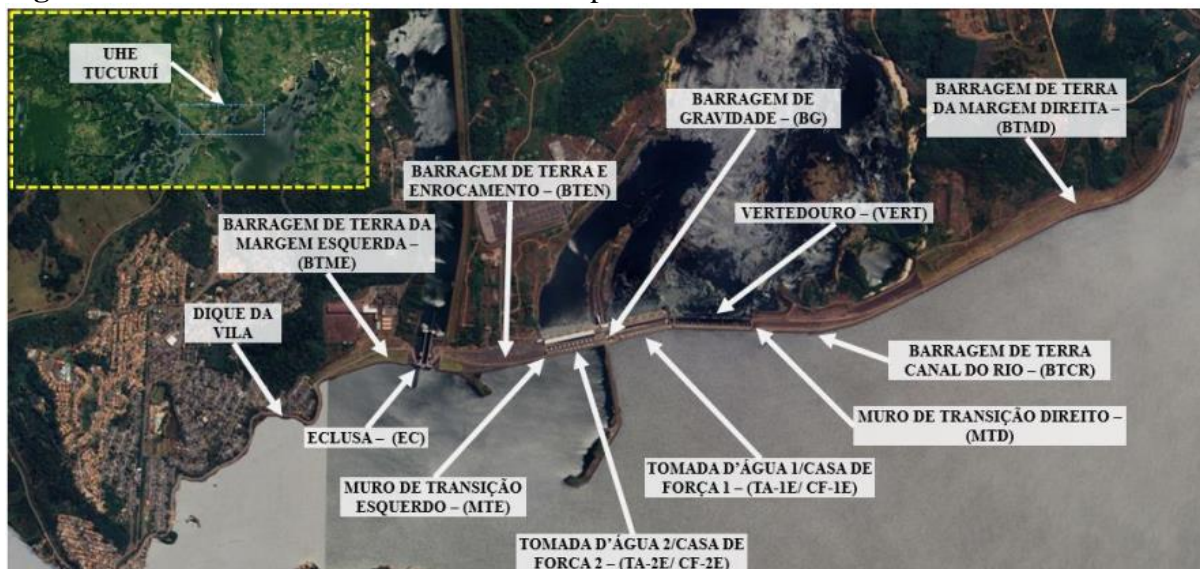
Figura 2 : UHE Tucuruí – Barramento Principal.
