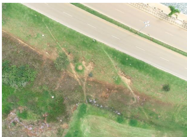
Figura 17. Vista área de surgências de água e processo erosivos decorrentes da formação de caminhos formado por pisoteio de pedestres no local.
