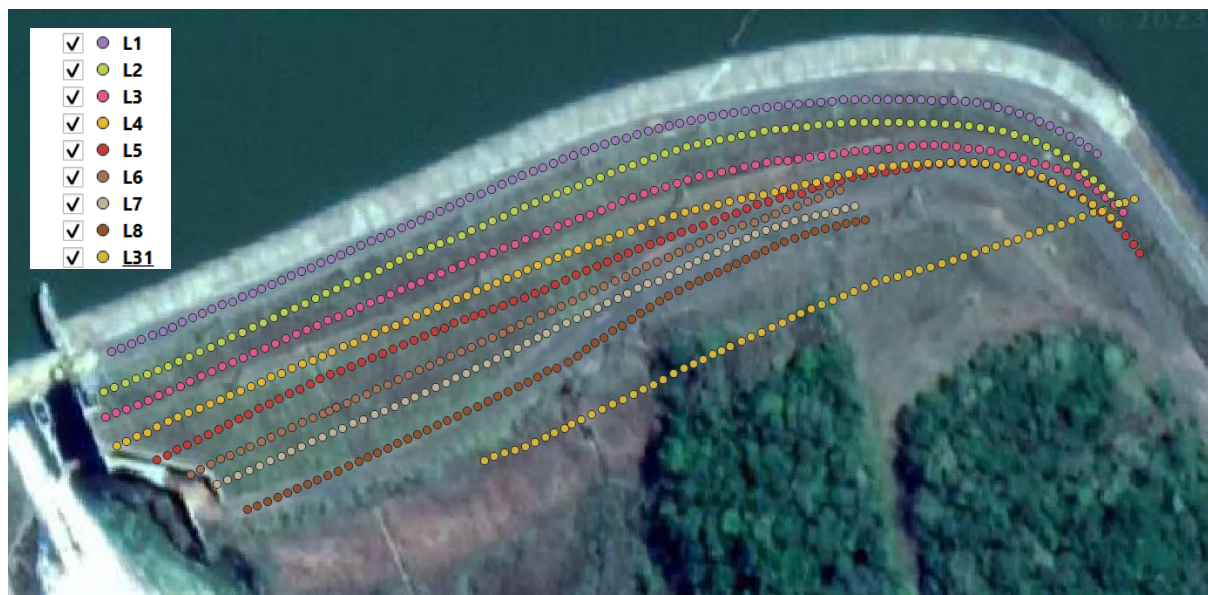
FIGURA 3 - DESENHO ESQUEMÁTICO DAS CAMPANHAS DE LEITURA NA BARRAGEM
