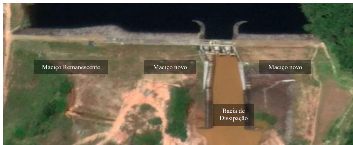
Figura 3. Vista geral da atual Barragem de Santa Helena, indicando o reaproveitamento da ombreira direita (maciço remanescente) e o maciço novo (reconstruído).
