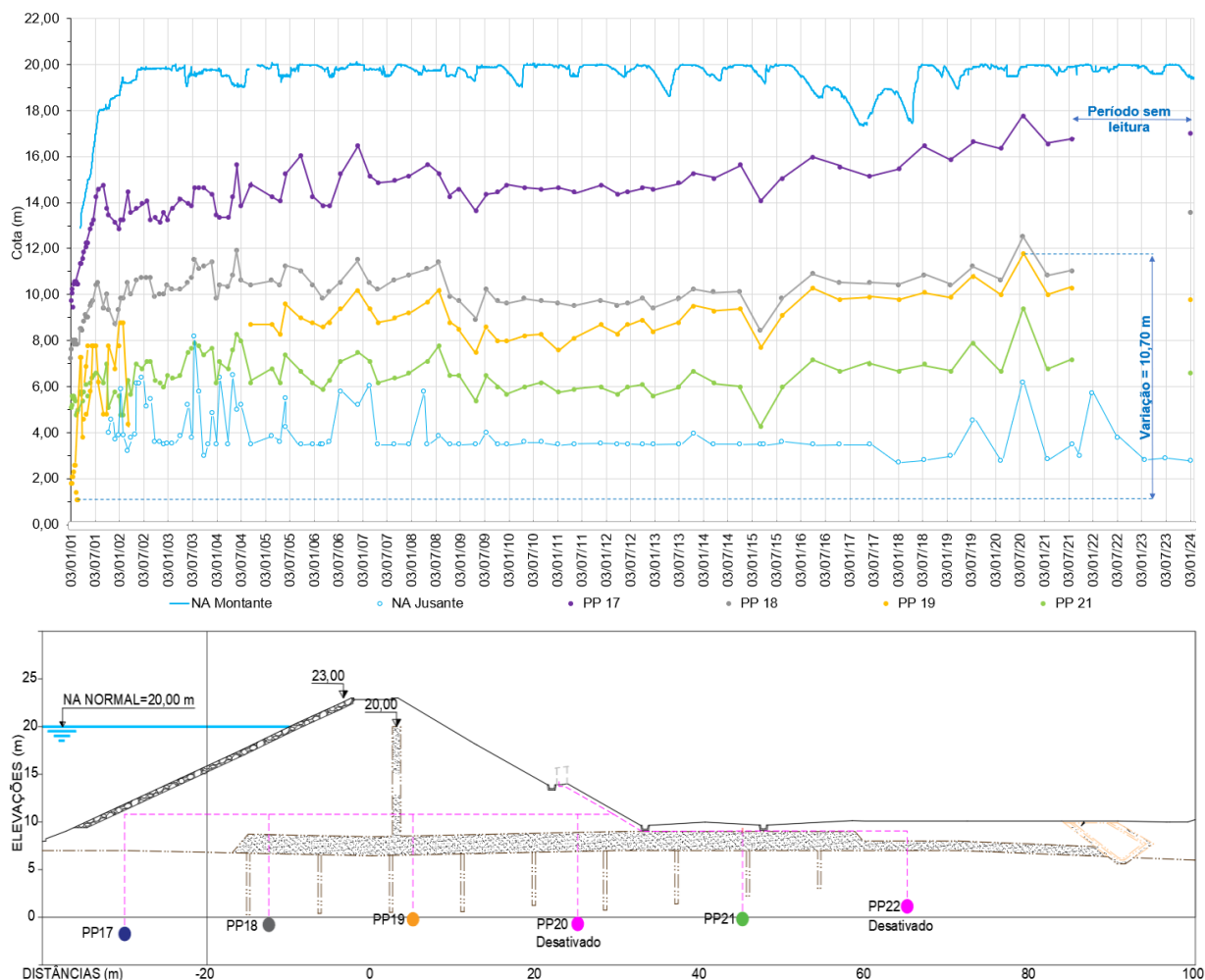
Figura 8. Evolução dos níveis piezométricos da seção 7.
