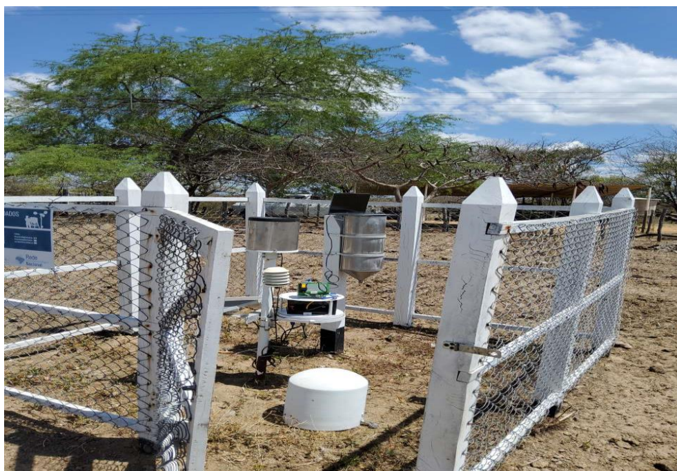
Figura 10 – Plataforma de coleta de dados com pluviômetro digital
