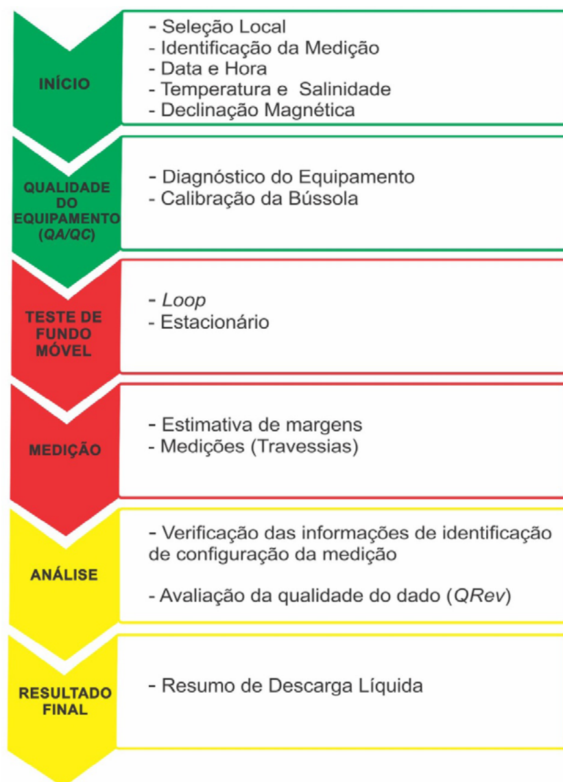
Figura 14 - Etapas de campo de uma medição. As etapas em verde correspondem aos procedimentos que devem ser realizados antes da medição, em vermelho durante a medição e em amarelo após a medição.
