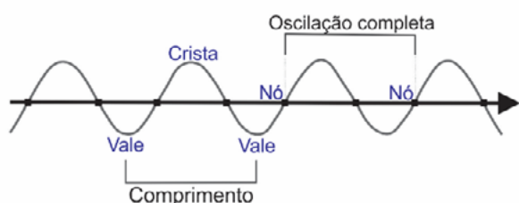
Figura 2 - Representação análoga das características da onda longitudinal.
