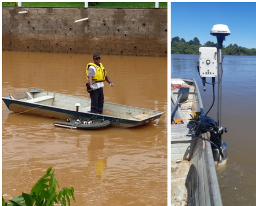
Figura 30 – À esquerda medição com cabo atravessado utilizando M9 com Hydroboard II acoplado em embarcação tripulada. À direita, M9 acoplado em suporte customizado para embarcação.
