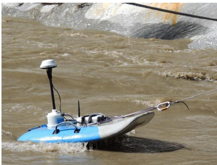
Figura 28 - Medidor acústico com pitch excessivo causado pela amarração.
