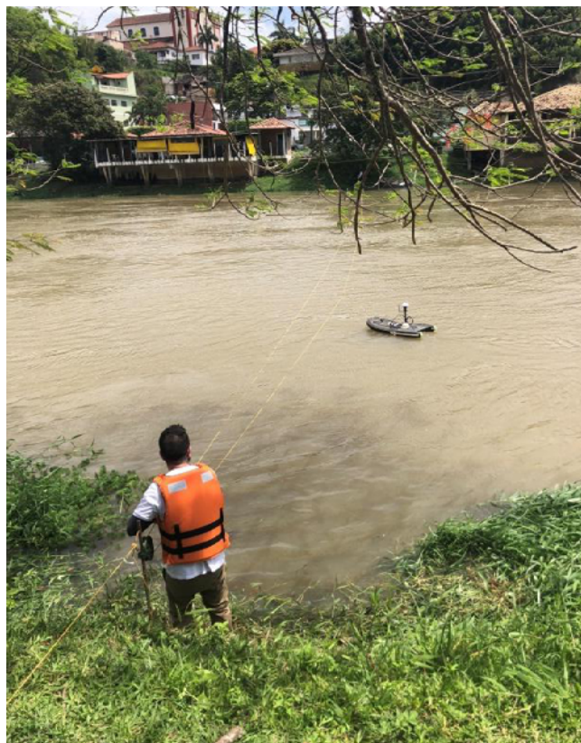
Figura 29 - Medição utilizando esquema de polias com M9 acoplado no Hydroboard II .
