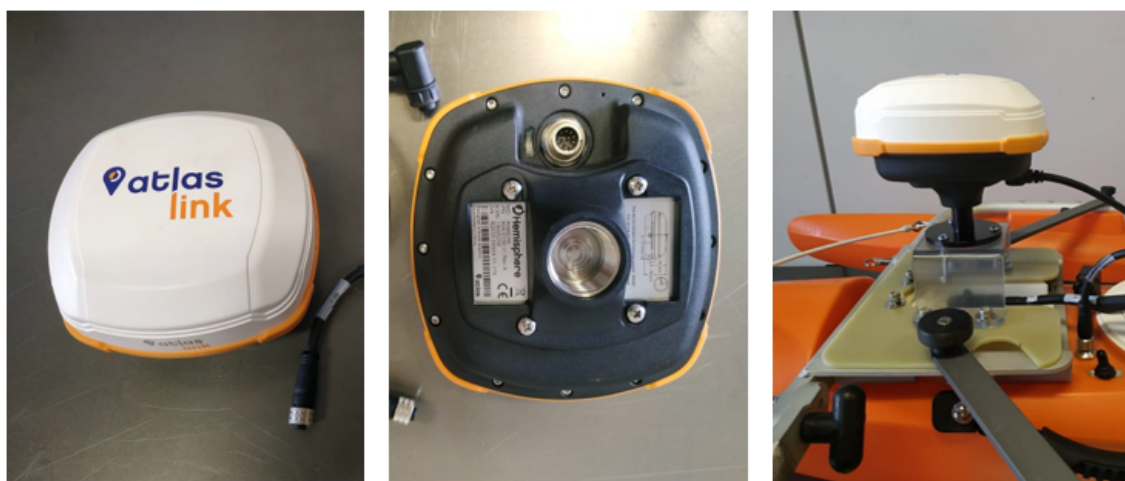
Figura 7 – Imagens da antena com receptor GNSS acoplada ao RiverRay
