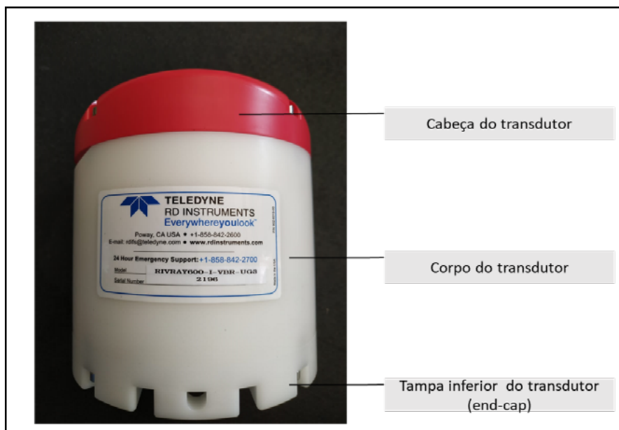
Figura 3 – Partes componentes do transdutor do ADCP RiverRay
