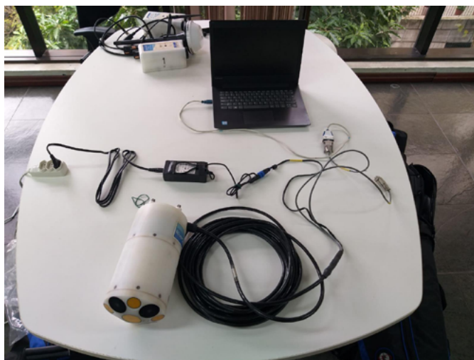
Figura 50 – Transdutor conectado diretamente à fonte de energia montado
