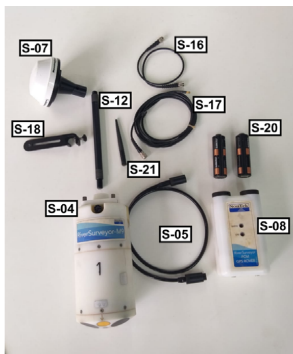
Figura 45 – Itens para montagem do ADP M9 acoplado à Hydroboard II
