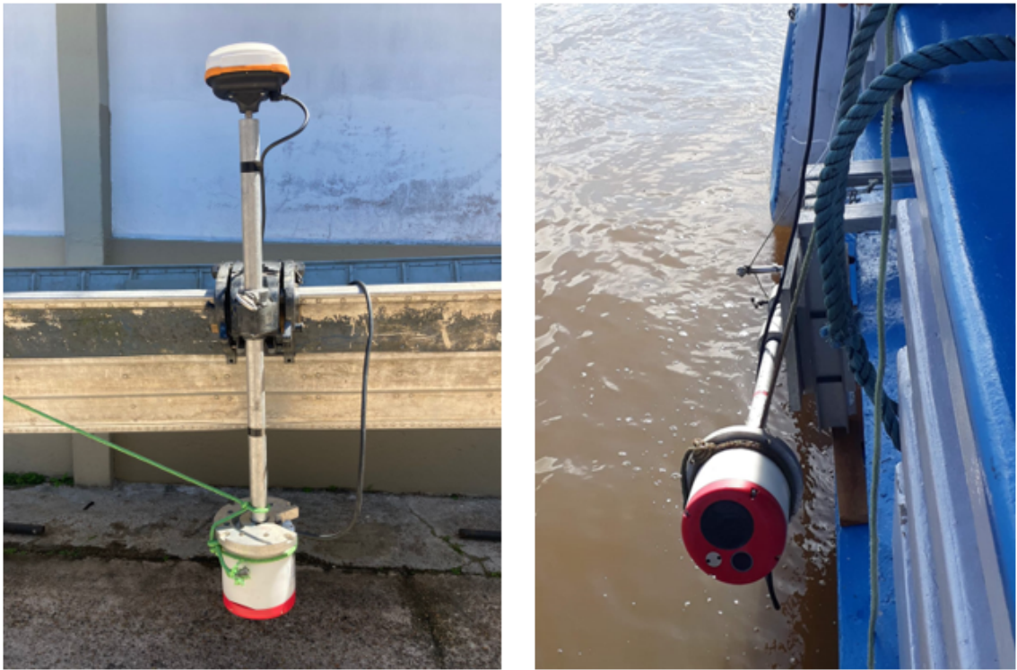
Figura 27 – Suporte adaptado instalado na lateral da embarcação
