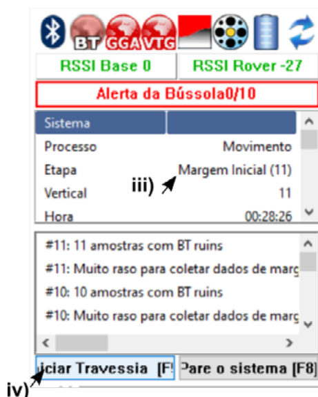
Figura 64 – Sequência de comandos para finalizar o perfilamento da margem inicial e iniciar a travessia
