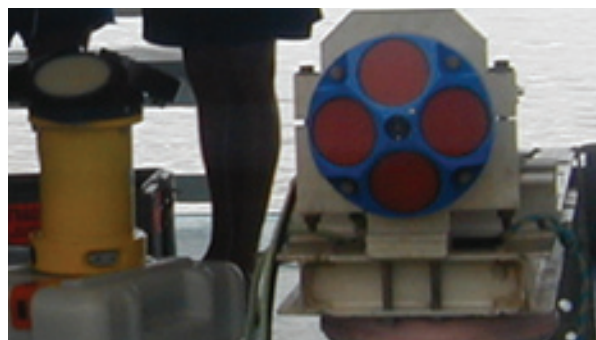
Figura 53 Vista dos 3 Transdutores do ADP e dos 4 transdutores acústicos do ADCP utilizados para emitir e receber os pulsos sonoros
