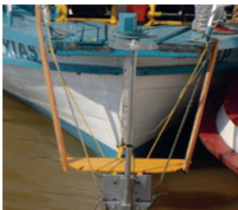
Figura 44 Eixo vertical fixado na proa do barco e medidor de ângulo
