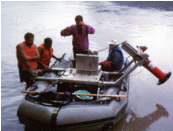
Figura 51 ADCP BB-DR e equipamentos instalados em "Bote" tipo ZODIAC no Rio Beni, Bolívia
