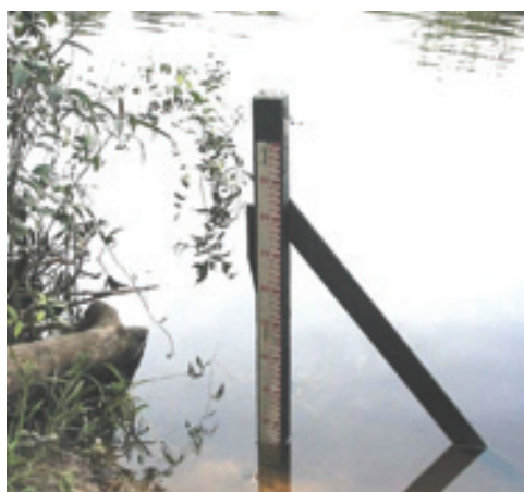
Figura 3 Régua de alumínio anodizado e pintada sobre concreto.
