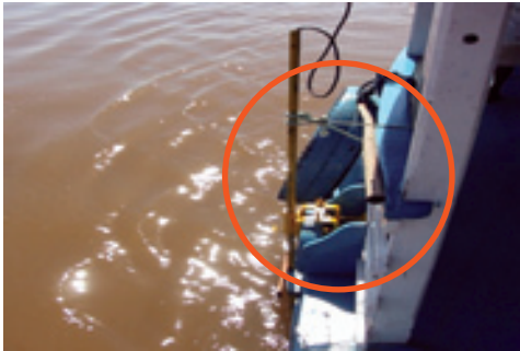
Figura 24 Instalação do Ecobatímetro na Lateral do Barco, Contador Digital de Pulsos e Registrador de Dados do Ecobatímetro.
