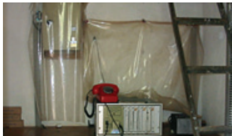
Figura 6 Linígrafos de pressão: de bolhas e transdutor eletrônico.
