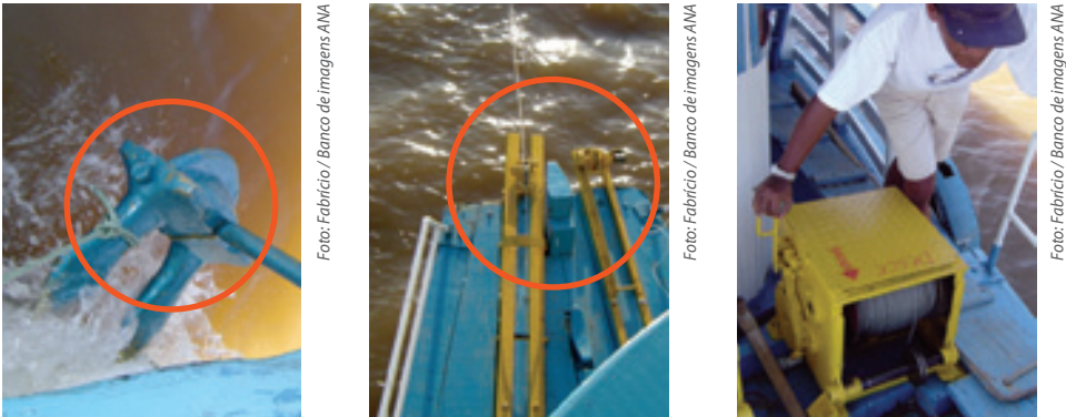
Figura 31 Procedimentos para ancoramento do barco (operação do guincho, detalhes do suporte e da âncora).
