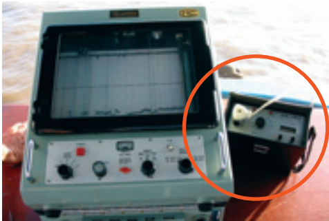
Figura 24 Instalação do Ecobatímetro na Lateral do Barco, Contador Digital de Pulsos e Registrador de Dados do Ecobatímetro.
