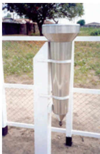
Figura 9 Pluviômetros “Ville de Paris” e modelo DNAEE e proveta.
