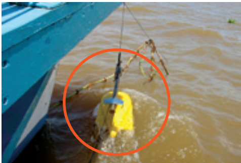
Figura 23 Estrutura do Guincho (Cabo de Aço e Medidor da Profundidade do Molinete) e do Molinete e Lastro (Formato Hidrodinâmico)
