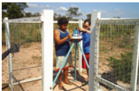
Figura 11 Pluviógrafo digital (sensor de chuva com datalogger).
