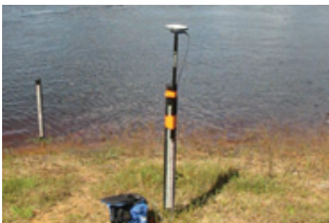
Figura 17 Utilização DGPS na margem (base) e no barco (móvel).
