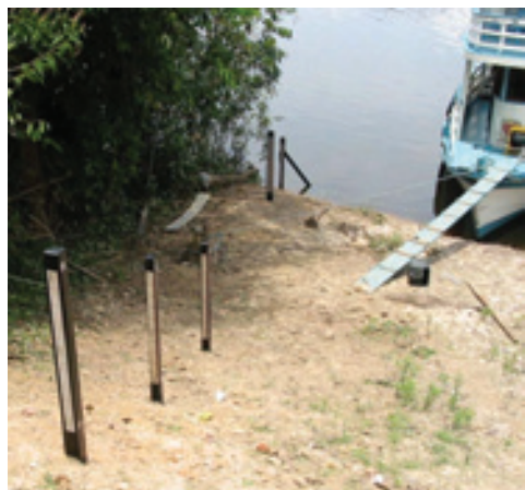
Figura 4 Seção de régua sem escadaria com escadaria.
