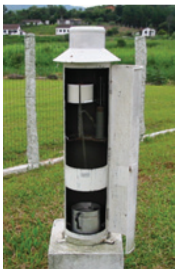
Figura 10 Pluviógrafos de bóia, de balança e cubas basculantes (PCD).
