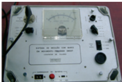
Figura 41 Alvo próximo à margem e Contador de Pulsos pelo Método Barco em Movimento
