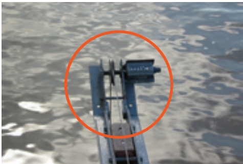
Figura 23 Estrutura do Guincho (Cabo de Aço e Medidor da Profundidade do Molinete) e do Molinete e Lastro (Formato Hidrodinâmico)
