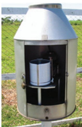
Figura 10 Pluviógrafos de bóia, de balança e cubas basculantes (PCD).
