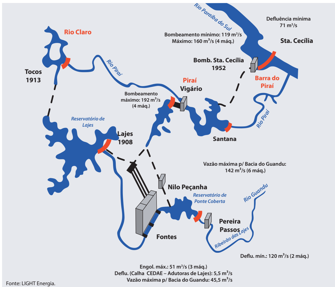
Figura 3.2.1: Esquema representativo do Sistema de Transposição das Águas da Bacia do Rio Paraíba do Sul para a Bacia do Rio Guandu
