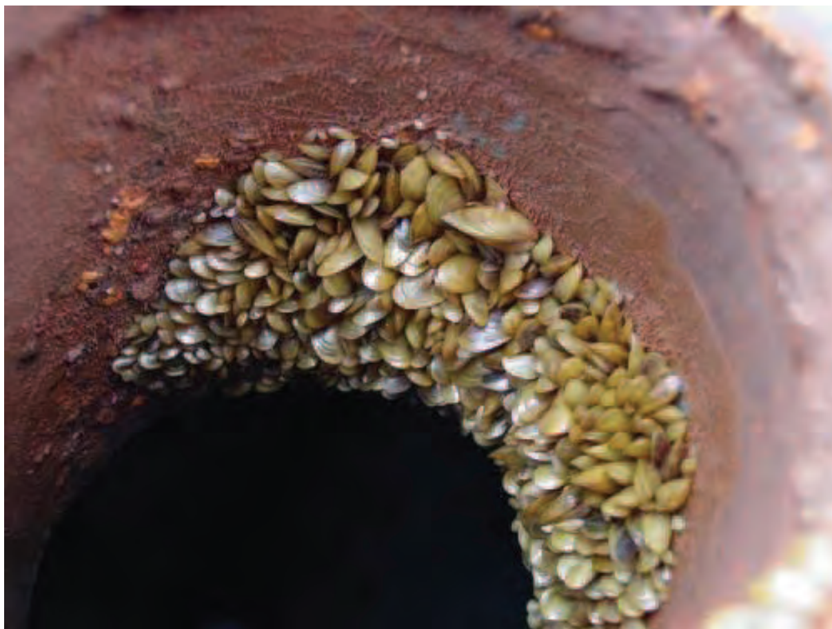
Figura 80 - Colônia de Mexilhão Dourado em Tubulação
